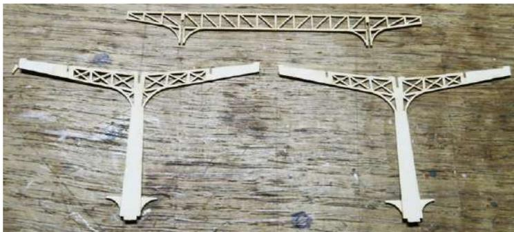
Une poutrelle ajourée rassemble les deux montants au niveau de leur axe transversal.
